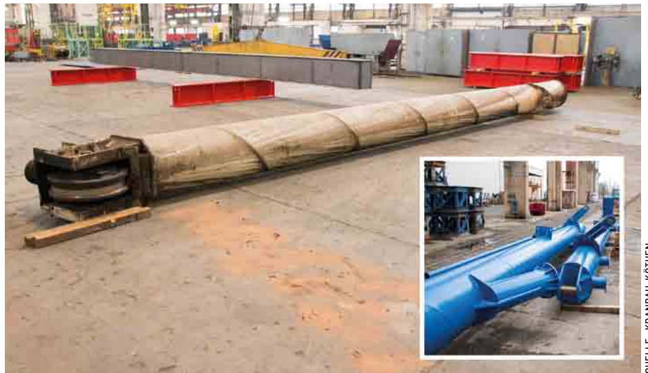
Vergleich: Zustand der Stützen bei Anlieferung und vor Rücktransport zum Kunden.
