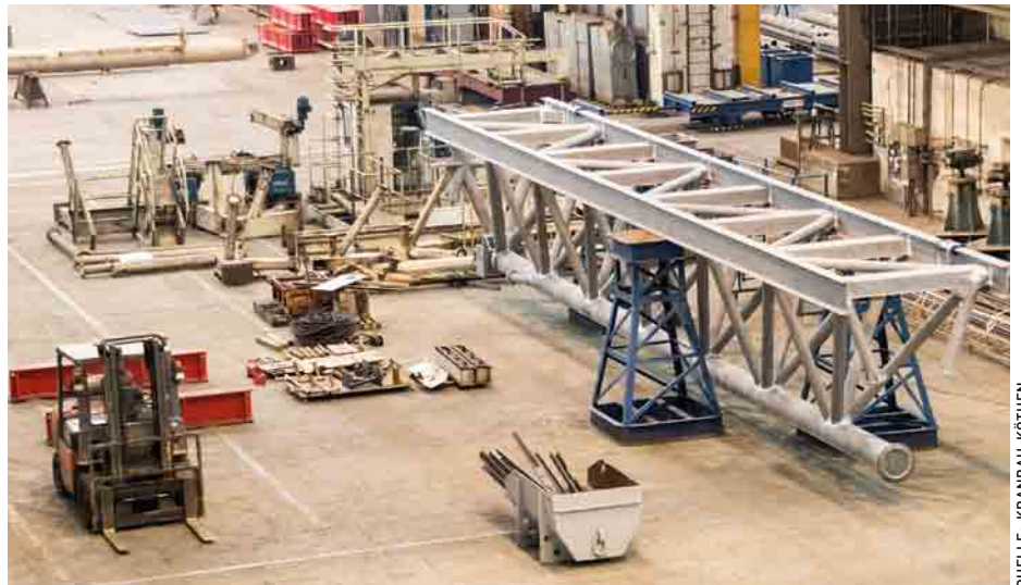
Anlieferung des Altkrans, erste Sandstrahlarbeiten
